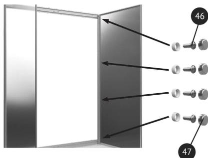
**ЭТАП 7** УСТАНОВКА ЗАДНИХ СТЕНОК И ЦЕНРАЛЬНОЙ СТОЙКИ
